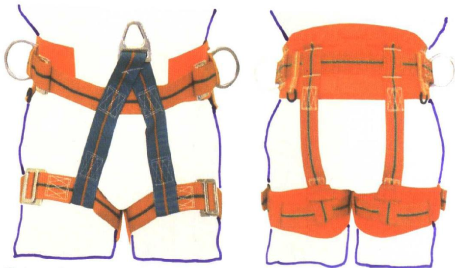
Cintura di posizionamento sul lavoro con 2 anelli laterali, con attacco ventrale per sospensione/evacuazione, sottocosciali imbottiti e regolabili. Norma EN 358
